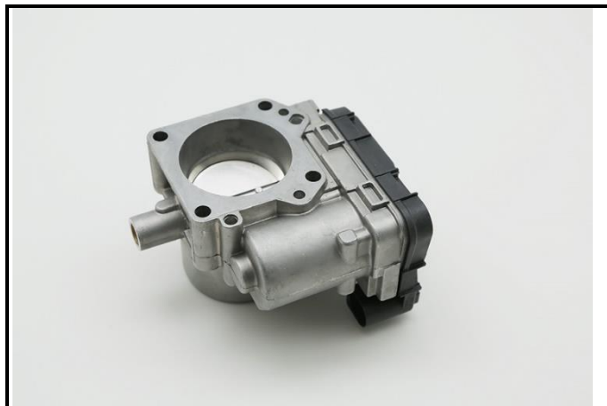
С11-4) Дроссельная заслонка - демонтированная
