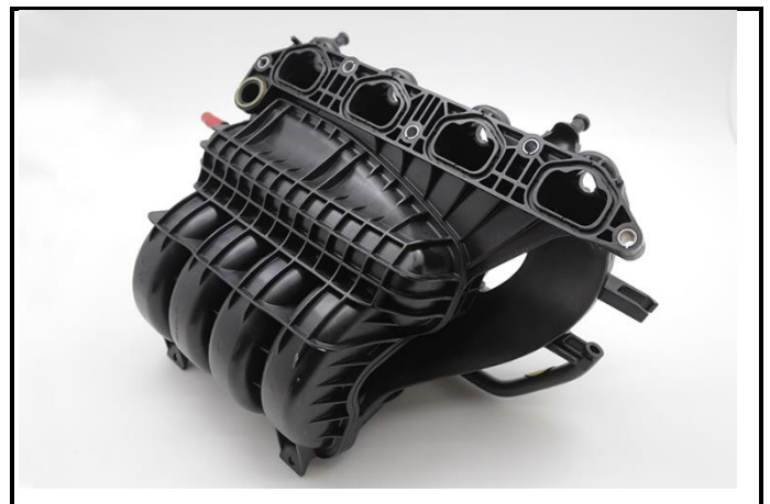
C11-2) Впускной коллектор - демонтированный
