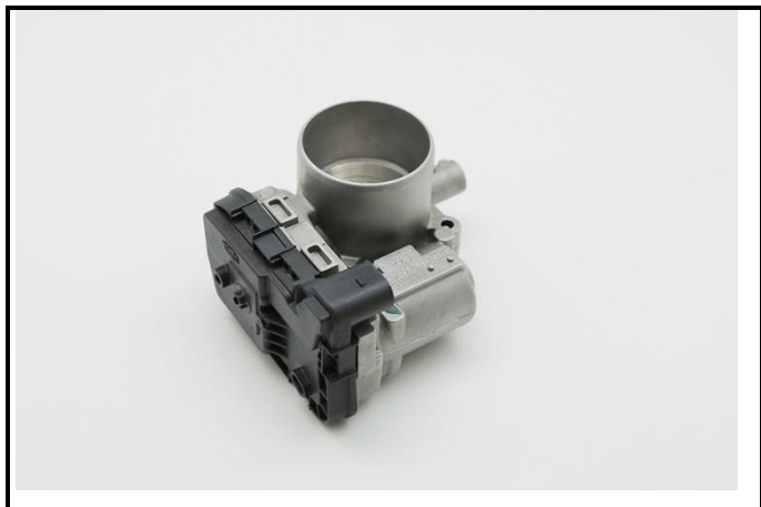
С11-3) Дроссельная заслонка - демонтированная
