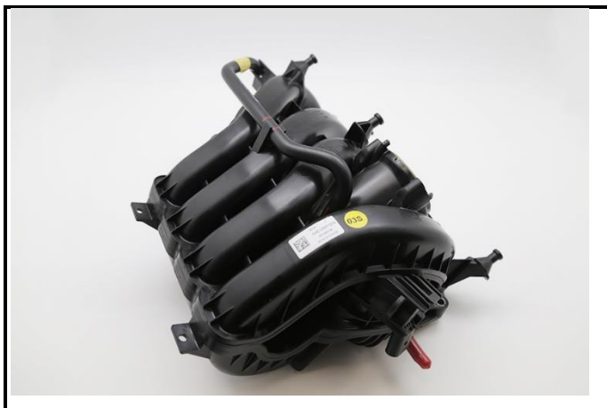
C11-1) Впускной коллектор - демонтированный
